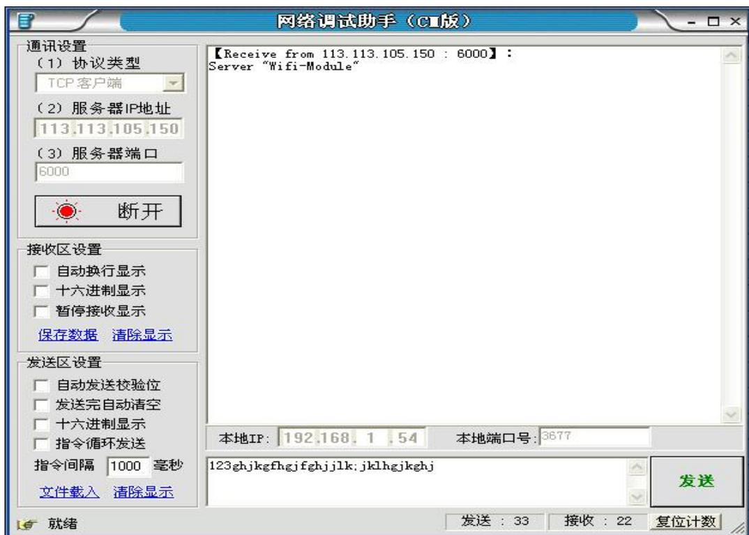
7. T310 通过串口连接一台电脑，打开超级终端，即可获得客户端发来的数据，
