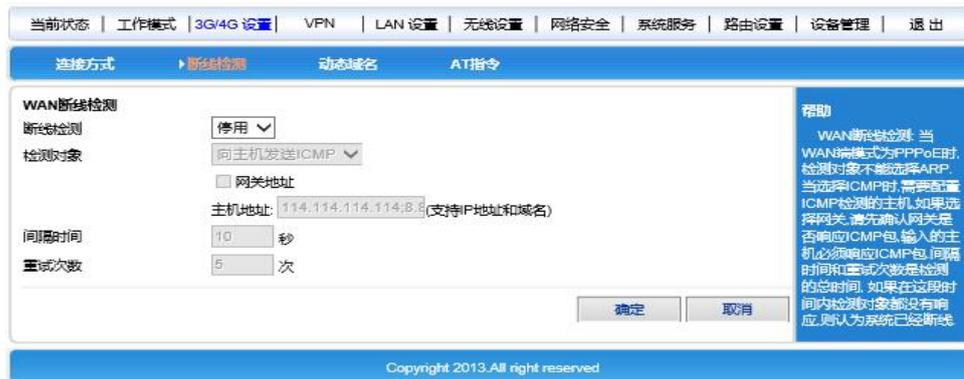
断线检测的工作原理是向指定的IP地址或者域名发送PING包，网络正常的情况下，发送的PING包能够收到主机IP或者域名的反馈。如果连续5次没有收到反馈，系统将判断为掉线了。将会重新拨号。（图片上的间隔时间和重试次数均可以修改）
