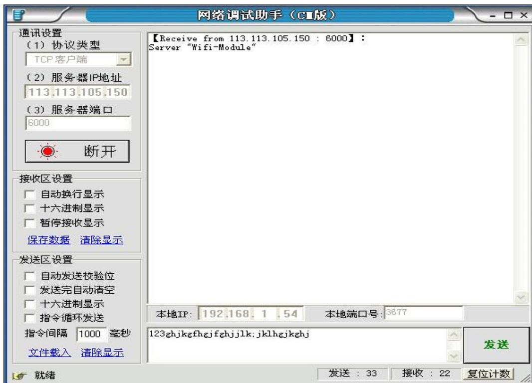
7. 5G 工业路由器通过串口连接一台电脑，打开超级终端，即可获得客户端发来的数据。
