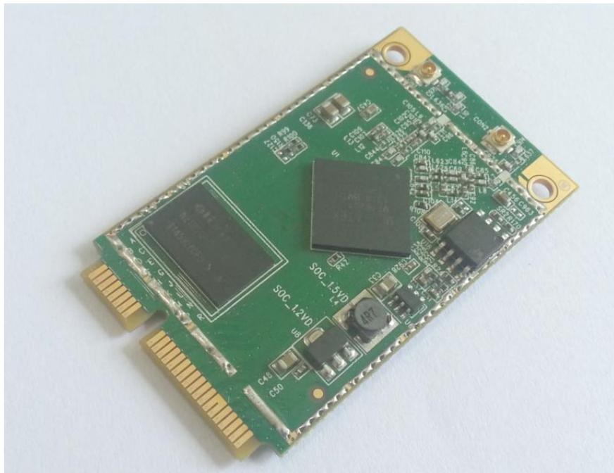
M390 是深圳市力必拓科技有限公司根据市场需求开发的一款高性能嵌入式路由器模块，提供丰富的接口，USB2.0 接口外挂 3G/4G 通信模块，存储、视频等外设。提供 2 个 LAN 口（其中一个可以做为 WAN 口使用），1 个 UART 接口，300Mbps 的 WIFI 无线网络以及众多的 GPIO 接口，用户可以方便的做外围应用开发。
