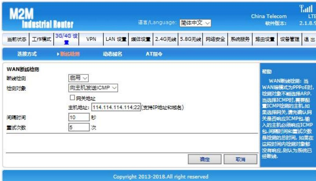
断线检测的工作原理是向指定的IP地址或者域名发送PING包, 网络正常的情况下, 发送的PING包能够收到主机IP或者域名的反馈。如果连续5次没有收到反馈, 系统将判断为掉线了。将会重新拨号。(图片上的间隔时间和重试次数均可以修改)
